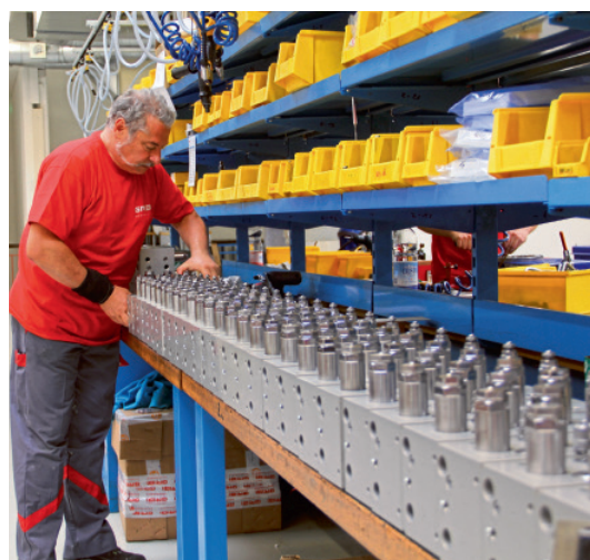
Der veredelte Steuerblock wird nun fertig montiert.
